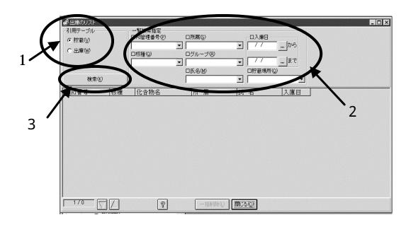
該当する RI が示されたら、実験に使う RI を選びクリック(図中1)して黒く反転させ、選択をクリックする(図中2)。
