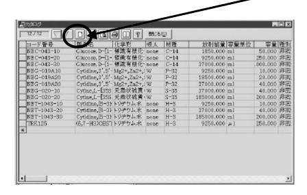
下記「カタログコードの編集(新規)」が表示されるので、定価以外の全て を入力し、<mark>登録</mark>をクリック。一つでも欠けると登録を受け付けないので注意。
