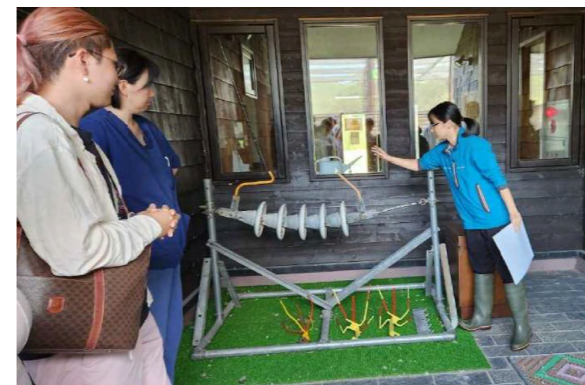
電線や鉄塔に設置するバードピンの試作品
